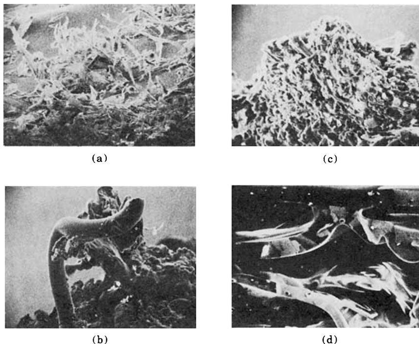
Fig. 2. Scanning electron micrographs: (a)- $\alpha$ -cellulose (100 $\times$ ); (b,c) fraction I (250 $\times$ , 100 $\times$ ); (d) fraction II, graft copolymer (250 $\times$ ).
